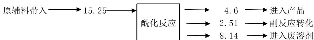
图 2.5.3-3 普仑司特工艺环节水平衡图 (kg/批)
