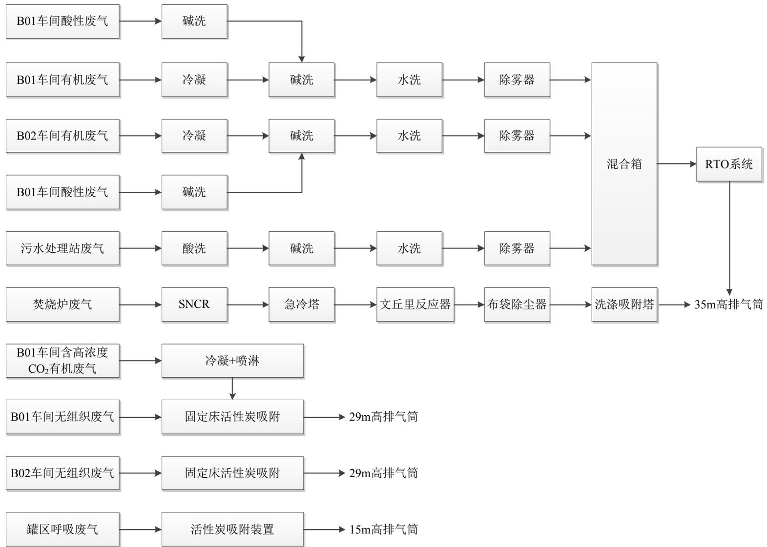
图 11.1-1 拟建项目采用的废气治理工艺框图
