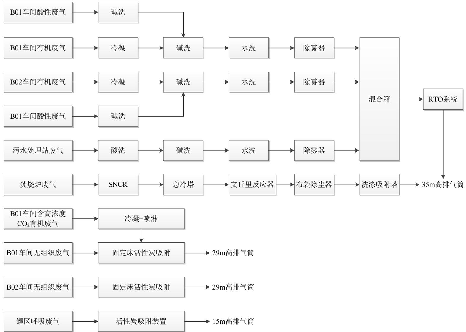
图 2.8-1 拟建项目采用的废气治理工艺框图
